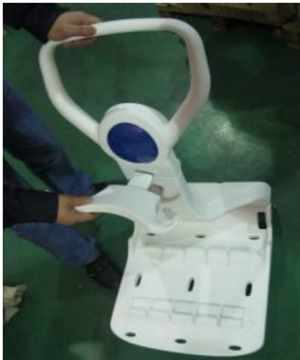
5.2.10, 写真の通りケーブルのホルダーを取り付ける。
