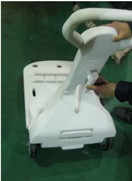
5.2.10, 写真の通りケーブルのホルダーを取り付ける。
